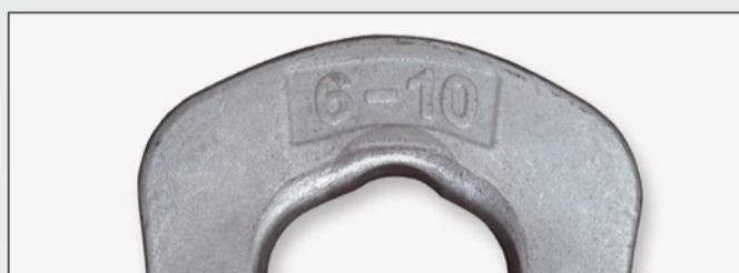
Druckstellen durch Anschlagmittel
